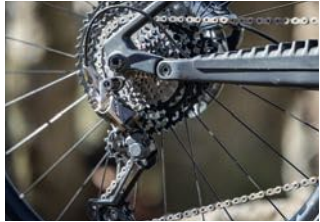
Kettenschaltungen eignen sich für häufige und schnelle Gangwechsel.
