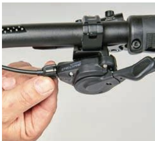
Über den Stellring am Schalthebel kann die Zugspannung erhöht werden.
