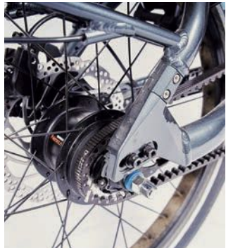
Ein Zahnriemen als Alternative zur Kette ist leise, sauber und fast wartungsfrei, bedarf aber eines speziellen Rahmens, da dieser, anders als eine Kette nicht geöffnet werden kann.
