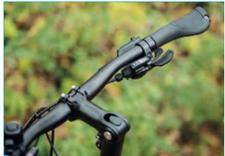
Die Gänge lassen sich bequem mit Druck und einem Finger wechseln.
