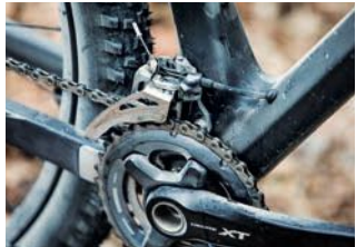
Der vordere Umwerfer wechselt die Kette zwischen den Kettenblättern.
