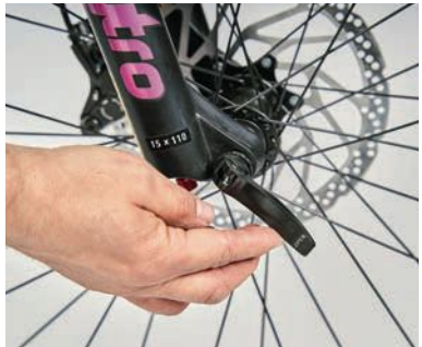
Steckachsen fixieren ein Laufrad optimal.
